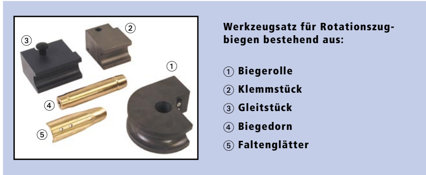
Abbildung 11: Werkzeugsatz für das Rotationszugbiegen.
