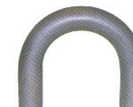
Tube acier 88,9 x 14 mm, cintré sur TUBOTRON 90
