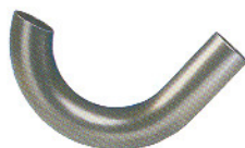
Tube CuNiFe 42 x 2 mm, cintré sur TUBOTRON 50
