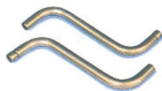
Tube laiton 12 x 1 mm, cintré sur TUBOBEND 20
